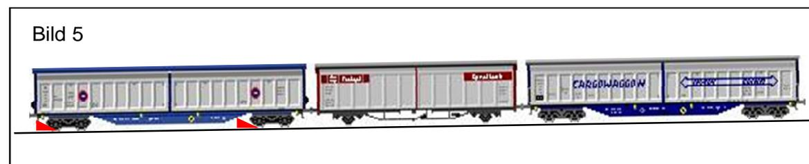
Weist die Wagengruppe eine größere Länge als 300 m auf oder sind mehr als 60 Achsen vorhanden, ist es je weiterer angefangener Länge von 300 m bzw. je weiteren angefangenen 60 Achsen erforderlich, zusätzlich 2 Sicherungsmittel im Sinne der obigen Regelungen zu verwenden.
